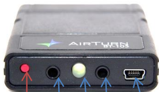
Power Ports 1&2 LED Ports 3&4 USB du BT-105 après 3 minutes.
